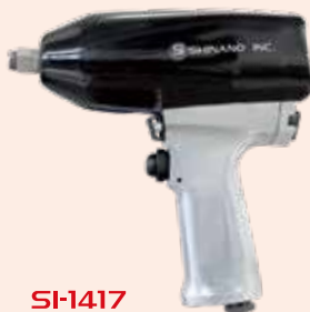
SI-1417 12.7mm 角インパクトレンチ 能力ボルト径: 16mm 最高トルク: 400Nm 全長: 190mm 質量: 2.5kg
